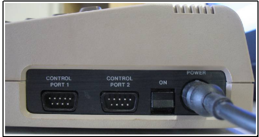
Лаконично и понятно: порты джойстиков, выключатель и разъем питания
